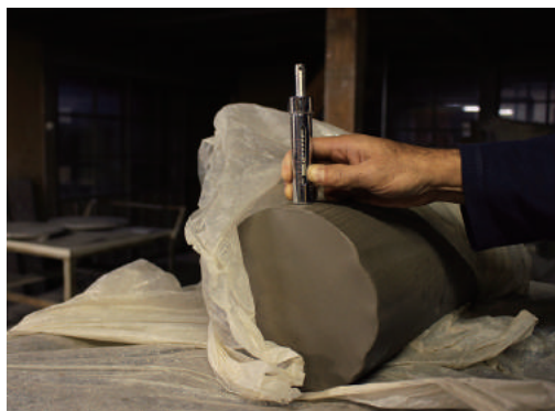
右上/神崎倍充さん。左下/硬度計で土の硬さをはかっている。右下/釉薬の濃さをしめす濃度計。
