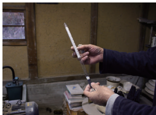
右上/神崎倍充さん。左下/硬度計で土の硬さをはかっている。右下/釉薬の濃さをしめす濃度計。
